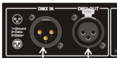
La connexion se fait via l'entrée DMX (DMX IN), avec une prise XLR 3 points. Cette prise est placée à l'arrière du Solano PRO Rack.
