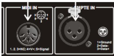
La connexion se fait via une prise XLR 3 points pour le signal SMPTE ou via une prise DIN 5 points pour le signal MIDI (MTC). Ces prises sont placées à l'arrière du Solano PRO Rack.
