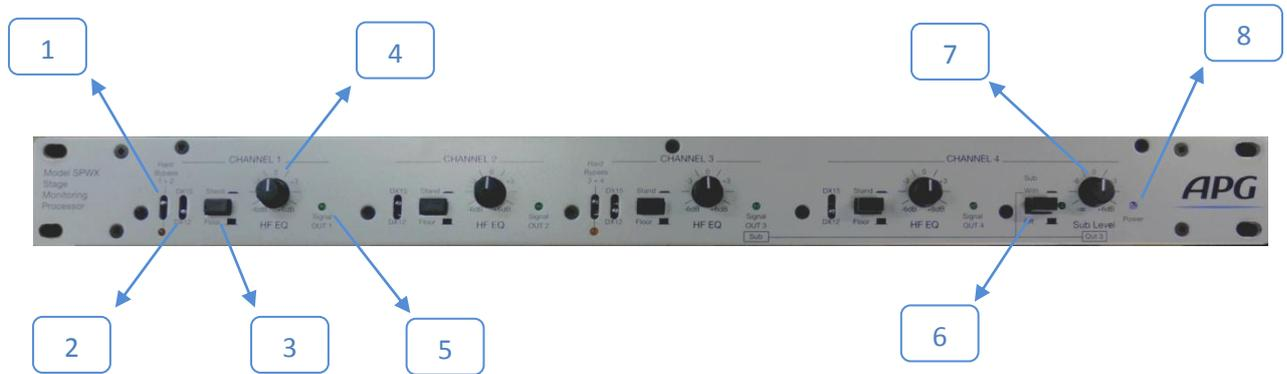
**1°) Hard-ByPass (1+2) / (3+4) :** Cette fonction permet de désactiver le processeur par paire de canaux (1+2 et 3+4). On pourra ainsi utiliser les canaux d'amplis isolés pour d'autres enceintes sans avoir à modifier le câblage interne d'un rack.
