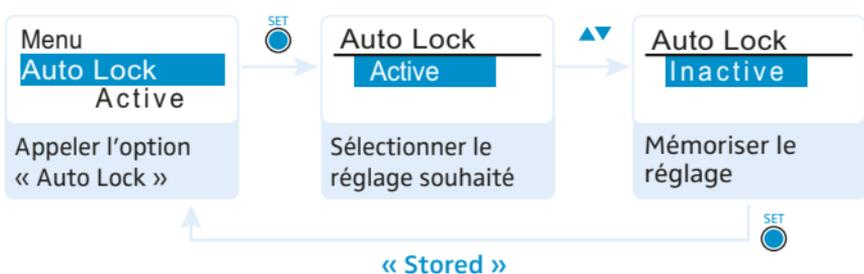
Le verrouillage des touches évite que l'émetteur de poche soit désactivé involontairement pendant le fonctionnement ou que des modifications soient effectuées. Le symbole d'activation du verrouillage des touches ⑤ 🔒 dans l'affichage standard actuel indique que le verrouillage des touches est activé.
