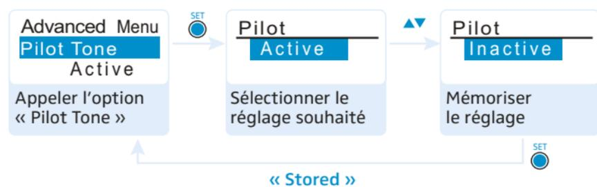
La fréquence du signal pilote est inaudible. Cette fréquence est émise par l'émetteur et analysée par le récepteur. Le signal pilote assiste la fonction anti-bruit (squelch) du récepteur. Ceci permet d'éviter les interférences causées par les signaux radio émis par d'autres appareils.
