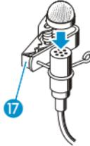
Le micro cravate ME 2 a une directivité omnidirectionnelle. Il n'est donc pas nécessaire de le positionner avec une grande précision.
