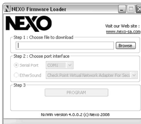
Choisissez alors le port série connecté au contrôleur TD amplifié NXAMP4x1 (note : seuls les ports détectés et disponibles apparaissent dans la liste) et finalement appuyez sur le bouton *Program*. La fenêtre suivante devrait apparaître à l'écran :
