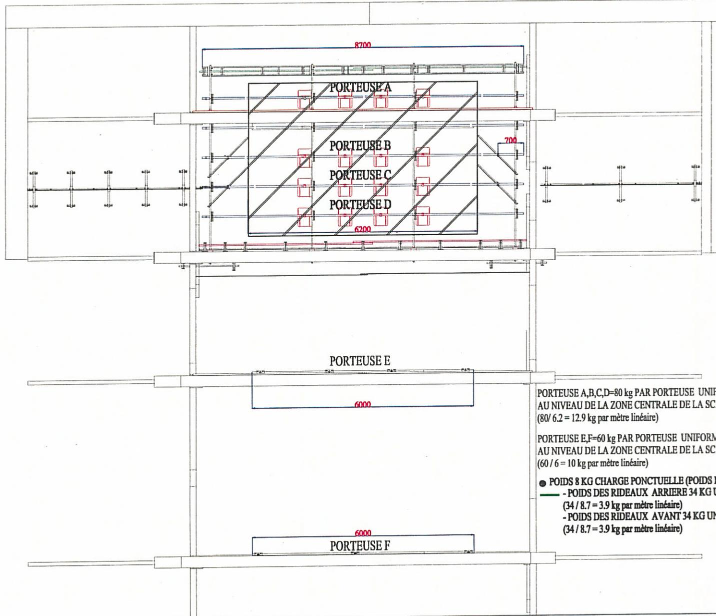
● PORTEUSE A,B,C,D=80 kg PAR PORTEUSE UNIFORMEMENT REPARTIE
