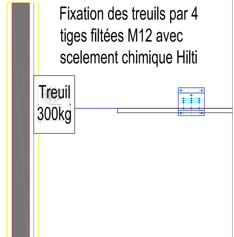
Fixation des treuils par 4 tiges filetées M12 avec scelement chimique Hilti
