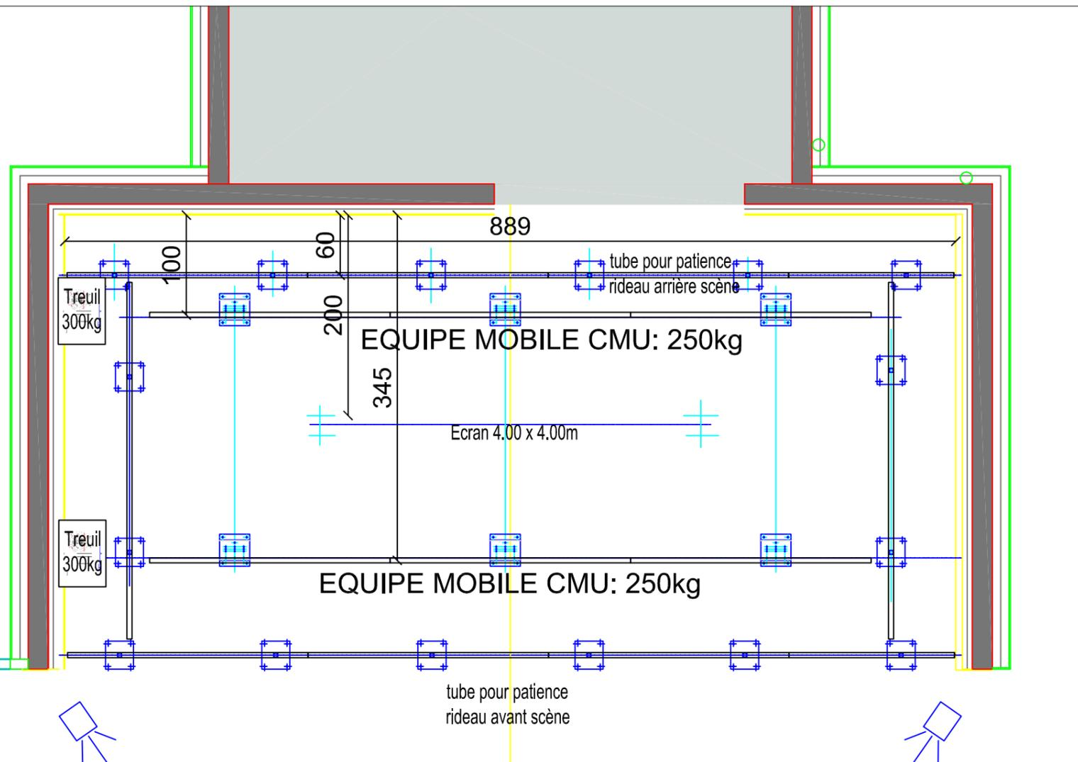
Fixation des treuils par 4 tiges filetées M12 avec scelement chimique Hilti
